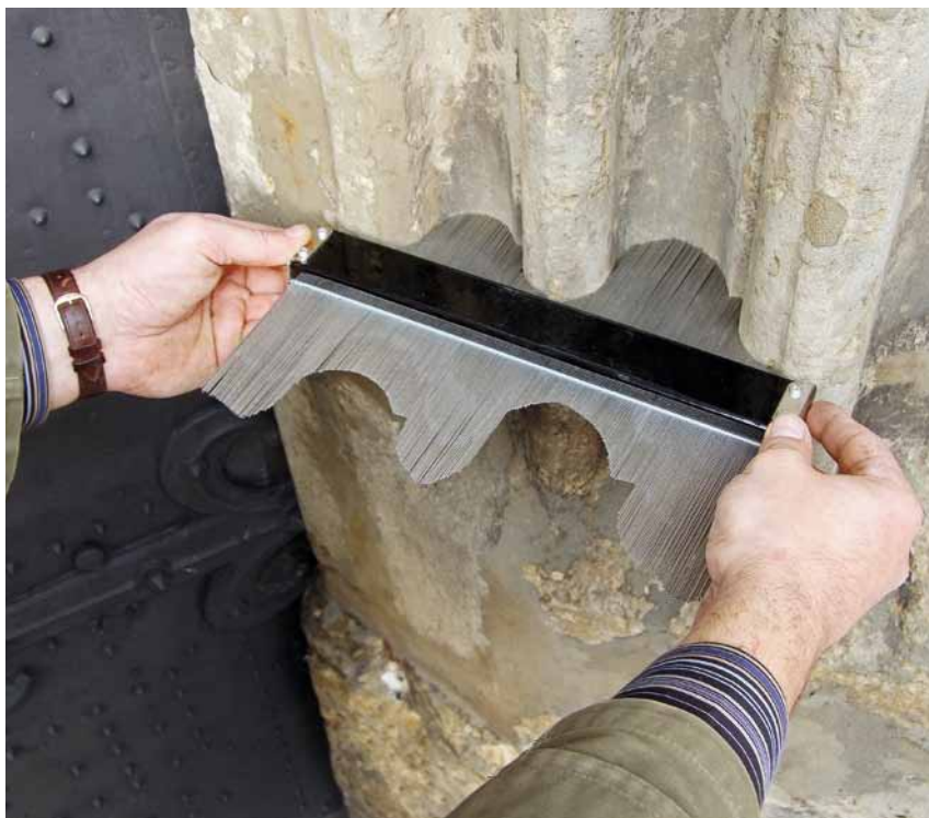
Obr. 7: Odebírání profilu prvku obrysovým hřebenem (foto F. R. Václavík, 2014).
