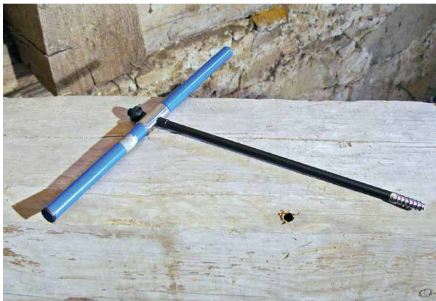
Obr. 17: Přírůstový (dutý) nebozez je nutné zavrtat kolmo ke středu kmenu. Získáme tak vzorek válcového tvaru, který předáme odborné dendrochronologické laboratoři ke zpracování (ilustrační foto T. Kyncl, 2006).
